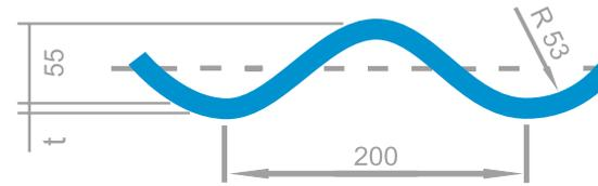
**Hamco Multi-Plate** Stahlfertigteile für Abzugstunnel, Silos und Wasserbehälter haben eine Wellung mit einer Wellentiefe von 55mm und einer Wellenlänge von 200mm. Fluchttunnel oder Einstiegsschächte können auch mit den kleineren Hamco Wellungen (152,4x22mm, 67,7x12,7mm) ausgeführt werden. Je nach Größe des Profils und der Belastung werden unterschiedliche Blechdicken von 2,00mm bis 8,00mm verwendet.
