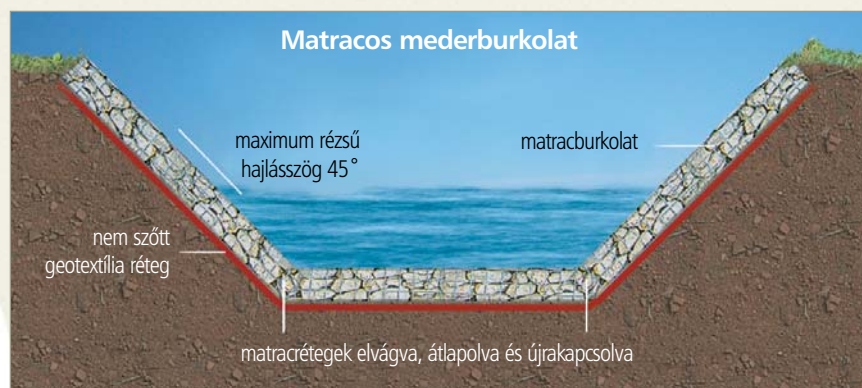
Matrac mederburkolás minta keresztzelvénye.
